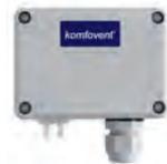
VAV – Steuerungsmodus ermöglicht die Aufrechterhaltung eines konstanten Luftdrucks im Kanal, während sich die Ventilator Drehzahl variable den Druckänderungen im Lüftungssystem, durch unterschiedliche Anforderungen in den belüfteten Räumen, anpasst. Der Luftdruck in den Kanälen wird durch optionale VAV Sensoren gemessen, die im Zuluft- und Abluftstrang installiert werden.
