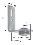
Ausführung aus verzinktem Stahlblech. Passend für Gewindestangen M8 und M10. Schalldämmelement aus EPDM-Gummi und Temperaturbeständig von - 40  $^{\circ}$  C bis + 120  $^{\circ}$ C Speziell entwickelt für Steigleitungen.
