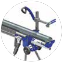
Ausrichten des Rohrs
