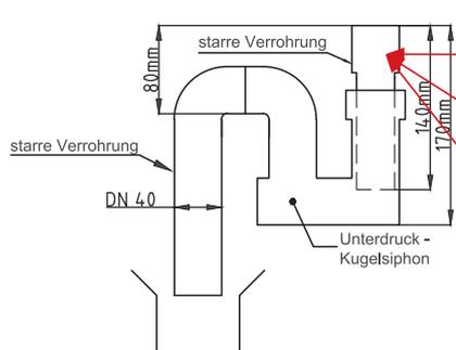
Beispiel: Kondensatanschluss mit Anbauerschraubungsstück und Kugelsiphon HL 136.3
