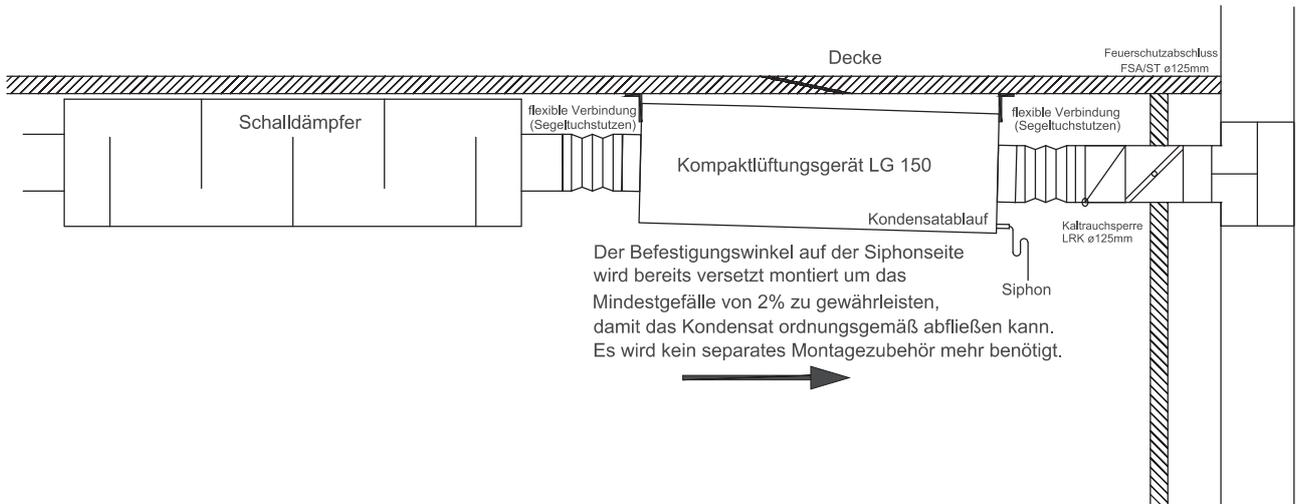
DETAIL KONDENSATANSCHLUSS DECKE
