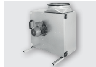
MPS...D (bis 11.840 m 3 /h) Küchenabluftbox, frequenzsteuerbar, Fördermitteltemperatur bis 120 °C zulässig, Anschluss Ø 225 – 500 mm
