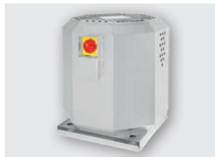
DVN (bis 15.300 m 3 /h) Küchenabluft, bis zu 120 °C, 400 V-Ausführung nur über Frequenzumrichter regelbar, Anschluss Ø 225 – 630 mm
