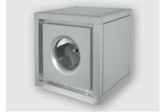
MPC...DT (bis 15.750 m 3 /h) Kubische Abluftbox für Küchenabluft, frequenzsteuerbar, bis max. 120 °C, Anschluss Ø 225 – 630 mm
