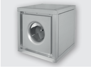
MPC (bis 15.750 m 3 /h) Hochflexible Abluftbox, bis max. 80 °C, variable Gestaltung der Ausblasrichtung, Anschluss Ø 225 – 630 mm
