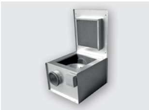
KVK (bis 1.037 m 3 /h) Schallgedämmter Rohrventilator, vorwärtsgekrümmt, Anschluss Ø 125 – 250 mm
