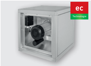
MPC...ECT (bis 6.710 m 3 /h) Kubische Abluftbox für Küchenabluft mit EC-Motor, Motor außerhalb des Förderluftstroms, bis max. 120 °C, Anschluss Ø 280 – 400 mm
