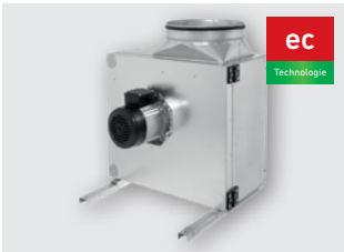
MPS...EC (bis 6.245 m 3 /h) Küchenabluftbox, EC-Motor, bis 120 °C, Motor außerhalb des Förderluftstroms, Anschluss Ø 280 – 400 mm
