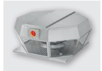
DHA...P (bis 11.950 m 3 /h) Horizontal ausblasend, mit Geräteschalter (Metall), 400 V-Ausführung nur über 5-Stufen-Trafo regelbar, Anschluss Ø 190 – 560 mm
