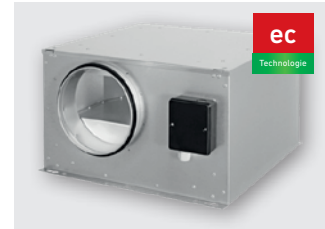
ISOR...EC (bis 4.480 m 3 /h) EC-Motor, vollisoliert, Anschluss Ø 125 – 500 mm
