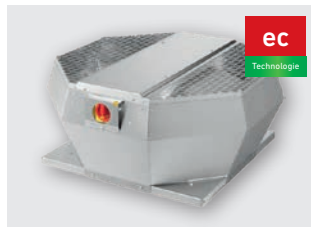
DVA...ECCP (bis 14.115 m 3 /h) vertikal ausblasend, mit Geräteschalter (Metall), mit EC-Motor und Konstantdruckregelung, Anschluss Ø 190 – 630 mm
