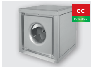
MPC...EC (bis 16.300 m 3 /h) Hochflexible Abluftbox mit EC-Motor, bis max. 60 °C, variable Gestaltung der Ausblasrichtung, Anschluss Ø 225 – 630 mm
