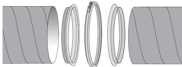
Primerne so za spajanje SPIRO cevi od Ø 80mm do Ø 200mm. Prirobnice PF pritrdimo na cev s pomočjo vijakov, kovic ali s točkovnim varjenjem.
