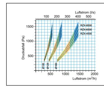
Der Druckabfall für den Arm, in gleicher Stellung wie die Maßskizze oben, wird durch die schwarze Linie dargestellt. Das Feld im Diagramm kennzeichnet den Druckabfall innerhalb des normalen Verwendungsbereichs. Die Farbänderungen zeigen die Luftgeschwindigkeiten im Absauger an, siehe unten. Die empfohlene Transportgeschwindigkeit für Schweißrauch ist 18 m/s.
